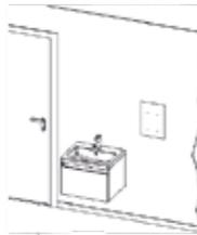
2. Die Bohrschablone an gewünschter Wandposition befestigen. Die 4 angegebene Löcher bohren.
