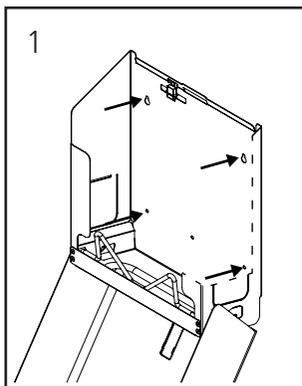
Befestigen Sie die Rückwand des Geräts mit den mitgelieferten Dübeln und Schrauben an der Wand.
