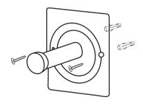
Ersatzrollenhalter mit Dübeln und Schrauben an der Wand befestigen.
